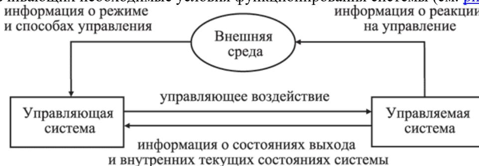
**Рис. 7.1.** Общая схема управления системой
